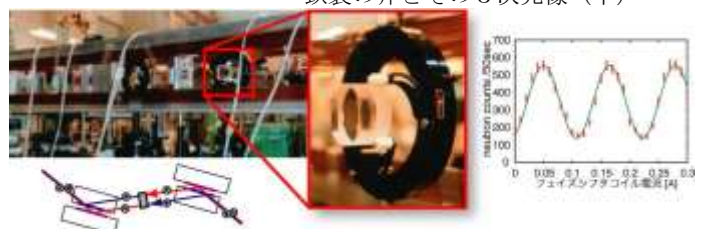
基礎物理をめざす冷中性子干渉計と測定された干渉縞
