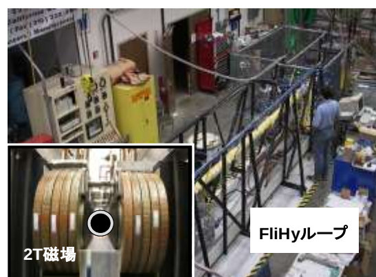
米国カリフォルニア大(UCLA)に設置した 2 T 磁場を有する日米共同電磁流体ループ
