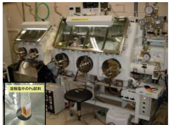
図一 2 溶融塩中でのアクチニド元素の化学特性を調べるグローブボックス
