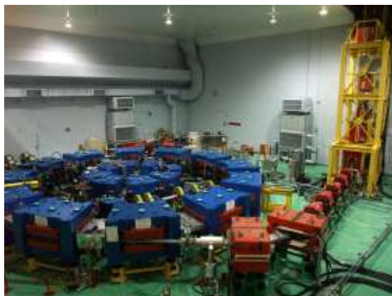
京大 FFAG 陽子加速器複合系：3 台のリングを用いて陽子ビームを 150MeV まで加速し、隣接する臨界集合体にビームを導入する。
