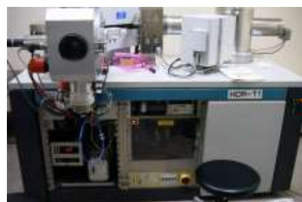
図一 3 表面電離型質量分析装置
